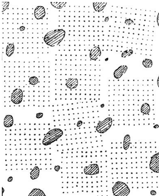
Рис. 99. Определение объемной доли \alpha -фазы точечным методом
